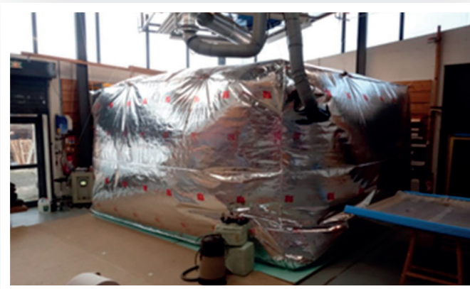
Caisson hermétique pour l'anoxie
